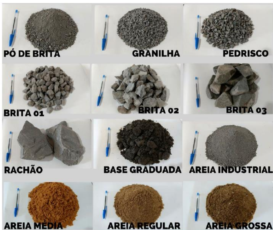
Figura 7: Agregados de várias granulometrias comumente utilizados na pavimentação
