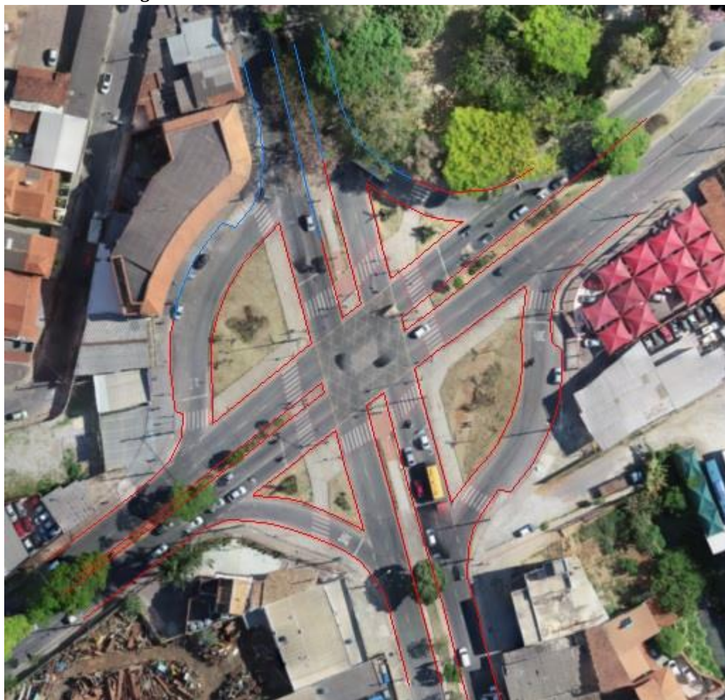
Figura 14 - Bordos Vetorizados do levantamento GNSS RTK
