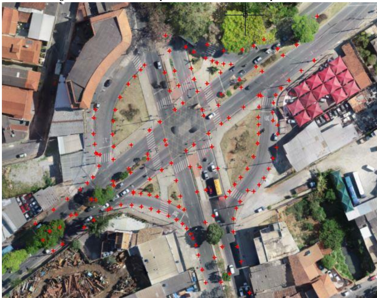
Figura 13 - Pontos levantados para cadastramento de bordos pelo GNSS RTK
